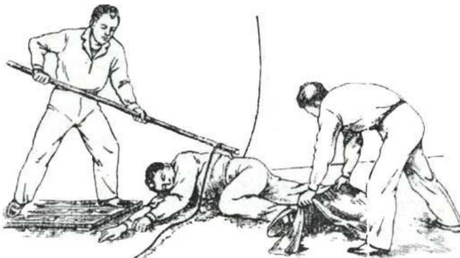
Рис. 3 - Звільнення потерпілого від дії електричного струму.
