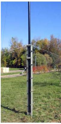
Ствол мачты состоит из отдельных трубчатых секций длиной **1,5 м**, которые выполнены из стальной тонкостенной трубы диаметром **63,5 мм** и снабжены переходниками для удобного и надежного соединения/разъединения секций мачты при ее подъеме/опускании. Общая длина секции с переходником **1,65 м**. Вес одной секции **4,5 кг**.
