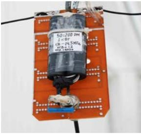
Рис.3. Трансформатор 50:200.
