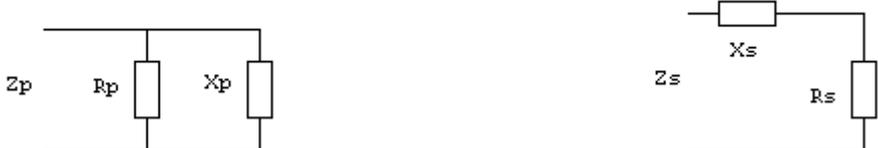
Например, пересчитаем последовательное соединение  $Z_s = 40 + j30 \Omega$  в параллельное  $Z_p$ .
