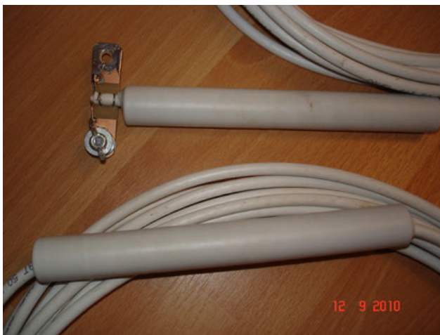
Дроссель из большого количества маленьких колец в термоусадочной трубке
